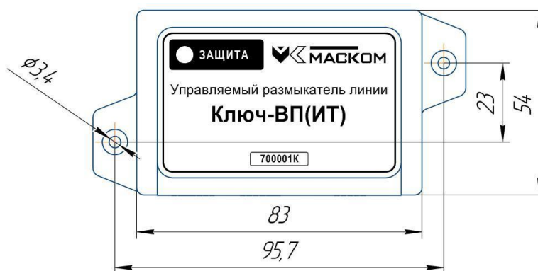
Рисунок 19 – Установочные размеры для изделий «Ключ-ВП(ИТ)» и «Ключ-ВП(СЛ)»
