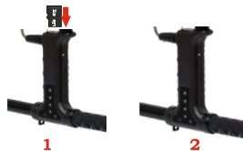
Рис. 6. Установка microSD карты
