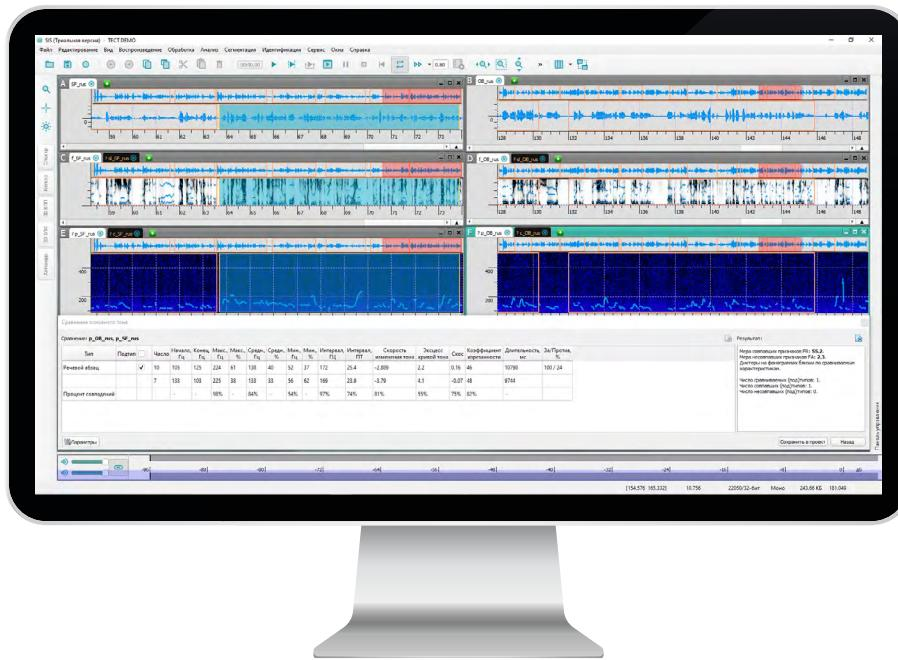
Идентификация диктора с помощью экспертизного метода сравнения параметров основного тона
