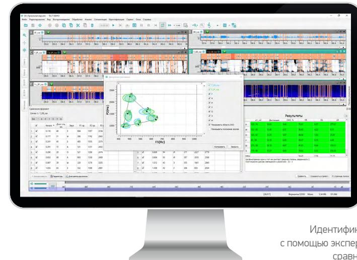
Идентификация диктора с помощью экспертного метода сравнения формант
