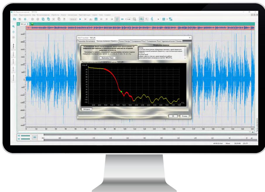
Проверка аутентичности фонограммы на предмет применения предварительной цифровой обработки
