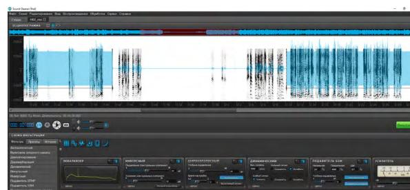
Одновременное отображение спектрограммы и осциллографмы для удобной, быстрой оценки участков сигнала и частот, где требуется обработка
