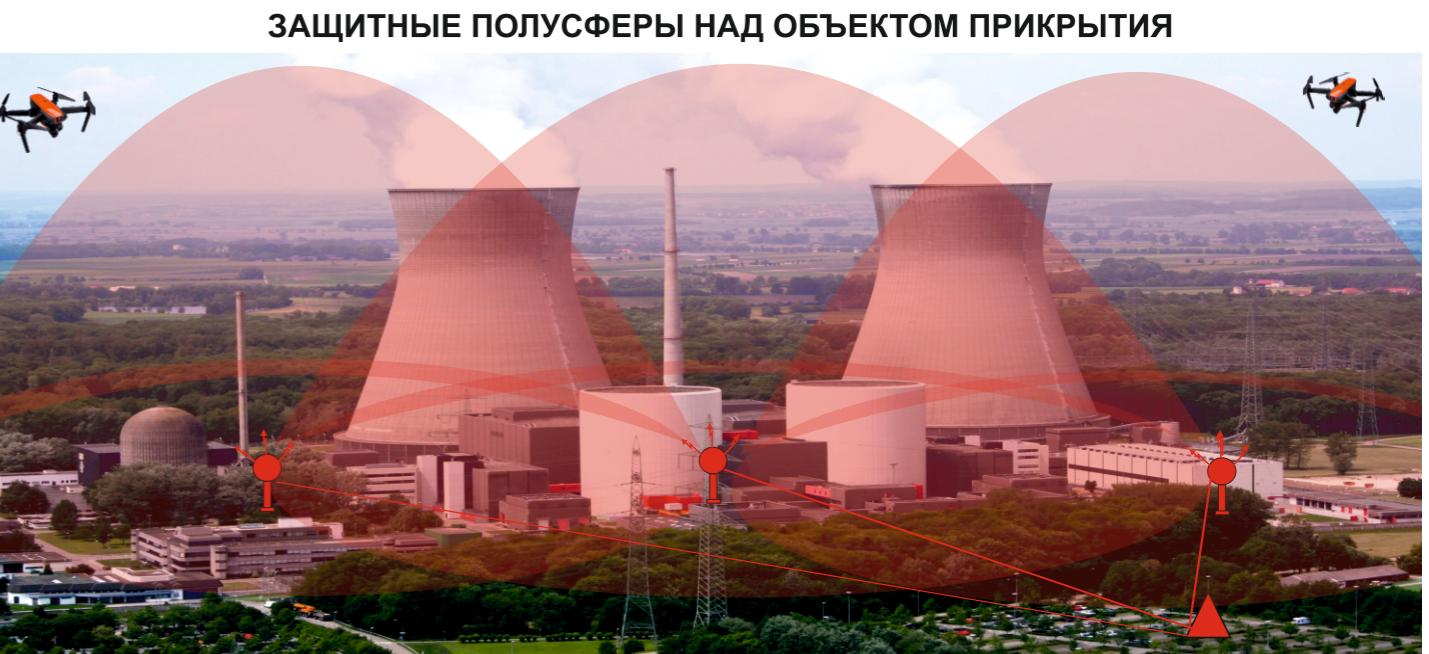
Пример прикрытия объектов большой площади с применением одновременно трех станций радиоэлектронного подавления объединенных в единую сеть централизованного управления.
