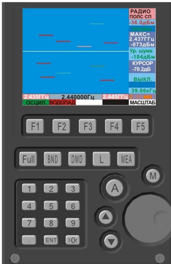
Отображает изменение спектра сигнала во времени и представляет собой цветовую проекцию амплитуды сигнала на частотно-временную плоскость
