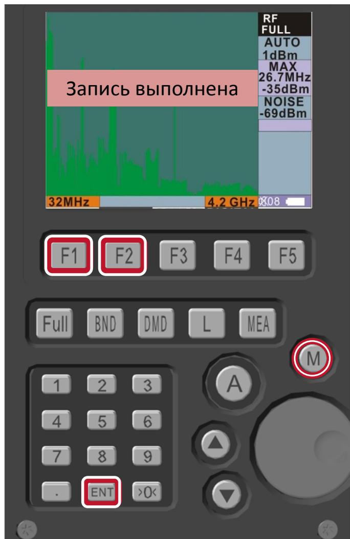
Предназначен для сохранения в энергонезависимой памяти изделия и последующим отображением изображения экрана, выделенного сигнала, результатов работы в подрежиме «АВТОМАТИЧЕСКИЙ АНАЛИЗ»
