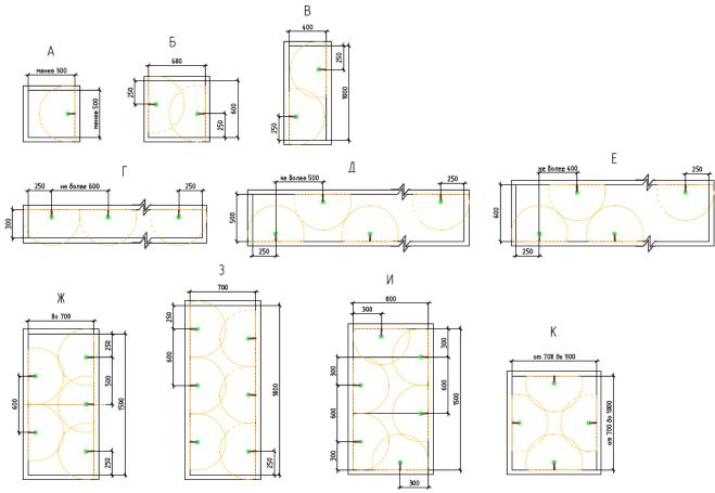
Виброизлучатели соединяются параллельно. Для установки используют крепления КР-1 и КР-4
